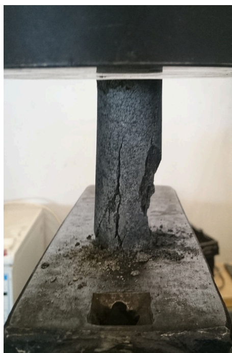
Figur 6.6: Prøveopstilling for UCS. Billedet er taget umiddelbart efter aflastning.
