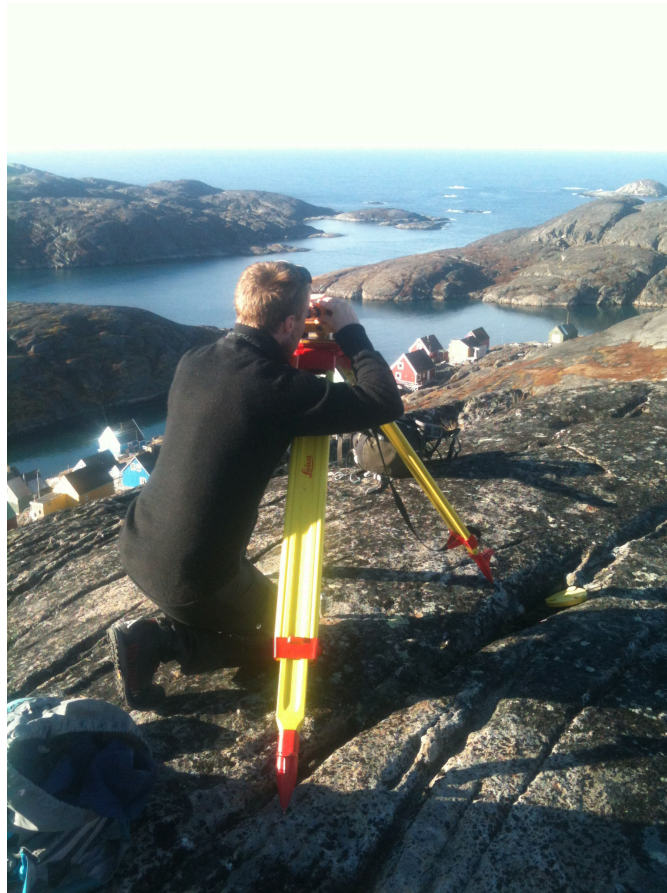
Figur 6.1: Opsætning af base-GPS i punkt 71942.
