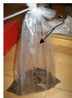
FIGUR 18: PID-MÅLER. LÆNGST TIL VENSTRE SES PID-MÅLEREN. PÅ BILLEDET I MIDTEN SES HVORDAN DER BLEV MÅLT, VED AT PRIKKE ET HUL I RILSAN POSEN MED PID-MÅLEREN. TIL HØJRE SES EN RILSAN POSE MED JORDPRØVE I OG DET KAN ANES (SE PILEN) AT HULLET ER BLEVET DÆKKET MED TAPE
