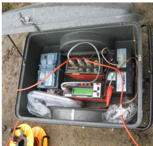
FIGUR 14: ABEM TERRAMETER SYSTEM (NEDERST I BILLEDET) MED TILHØRENDE ELEKTRODE SELEKTOR ES 464 TERRAMETER SYSTEM (ØVERST I BILLEDET) BEGGE TILSLUTTET BILBATTERI. INSTRUMENTERNE ER PLACERET I EN CYKELTRAILER, DA DET SÅ ER NEMMERE AT TRANSPORTER.
