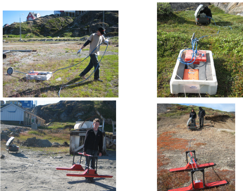
FIGUR 7: DE TO ØVERSTE BILLEDER VISER HVORDAN MÅLINGERNE MED DE HØJFREKVENTE ANTENNER BLEV FORTAGET. PÅ DE NEDERSTE TO BILLEDER KAN SES OPSTILLINGEN MED DEN LAVFREKVENTE ANTENNE, HVOR CYKELTRAILEREN VAR BAGVED ANTENNEREN HELE TIDEN. BILLEDERNE TIL VENSTRE ER TAGET PÅ GTO PLADSEN OG BILLEDERNE TIL HØJRE ER FRA DEN INDTØRREDE SØ HVOR DER BLEV FORETAGET TEST AF OPSTILLINGEN.
