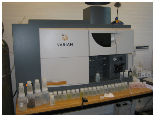
FIGUR 22: ICP SOM BLEV BENYTTET TIL TUNGMETALANALYSERNE. PRØVERNE KAN SES FORAN STÅENDE I SYREVASKEDE PLASTIKBEHOLDERE.
