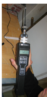
FIGUR 18: PID-MÅLER. LÆNGST TIL VENSTRE SES PID-MÅLEREN. PÅ BILLEDET I MIDTEN SES HVORDAN DER BLEV MÅLT, VED AT PRIKKE ET HUL I RILSAN POSEN MED PID-MÅLEREN. TIL HØJRE SES EN RILSAN POSE MED JORDPRØVE I OG DET KAN ANES (SE PILEN) AT HULLET ER BLEVET DÆKKET MED TAPE
