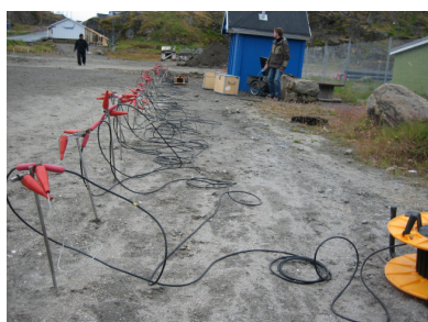
FIGUR 15: OPSTILLING AF MEP, HVOR DET FREMGÅR AT KABLERNE ER SAT PÅ SPYDENDE VED HJÆLP AF KROKODILLENÆB, SAMT AT CYKELTRAILEREN INDEHOLDENDE ABEM TERRAMETER SYSTEM OG ELEKTRODE SELEKTOR ER PLACERET I MIDTEN AF UDLÆGGET. EN PRINCIPSKITSE ER VIST TIL HØJRE.
