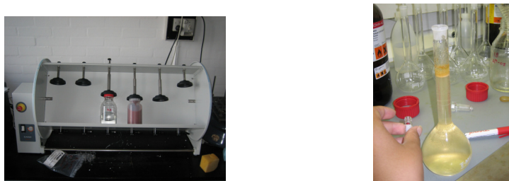
FIGUR 21: TIL VENSTRE SES HVORDAN NOGLE AF PRØVERNE BLEV RYSTET DA DER IKKE VAR MERE PLADS PÅ RYSTEBORDET SOM KAN SES I FIGUR 20. TIL HØJRE KAN SES UDTAGNINGEN TIL VIALS.
