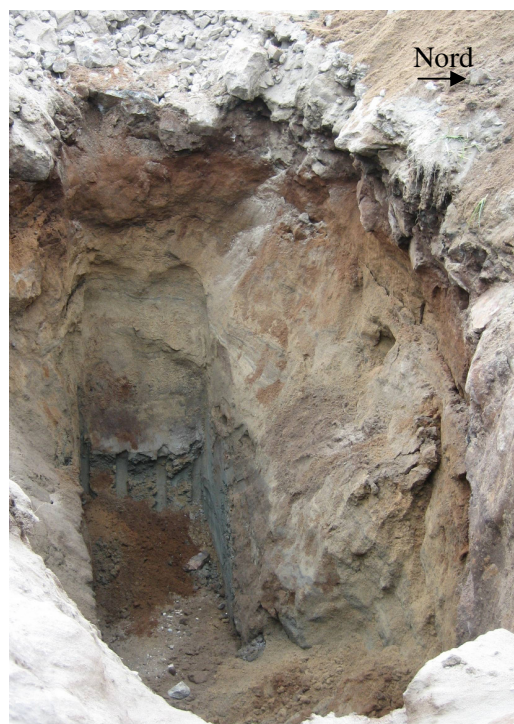
FIGUR 23: BOREPROFIL FRA GRAVNING 1 PÅ DEN SYDLIGE DEL AF GRUNDEN. PLACERINGEN ER VIST PÅ FIGUR 5 I AFSNIR 4.1 GRAVNINGER. GPS KOORDINATER FINDES PÅ BOREPROFILET VIST I BILAG C. TIL HØJRE SES ET BILLEDE TAGET NED I GRAVNINGEN MED NORD MOD HØJRE.
