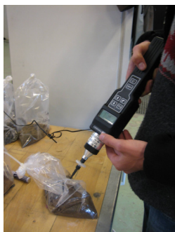
FIGUR 18: PID-MÅLER. LÆNGST TIL VENSTRE SES PID-MÅLEREN. PÅ BILLEDET I MIDTEN SES HVORDAN DER BLEV MÅLT, VED AT PRIKKE ET HUL I RILSAN POSEN MED PID-MÅLEREN. TIL HØJRE SES EN RILSAN POSE MED JORDPRØVE I OG DET KAN ANES (SE PILEN) AT HULLET ER BLEVET DÆKKET MED TAPE
